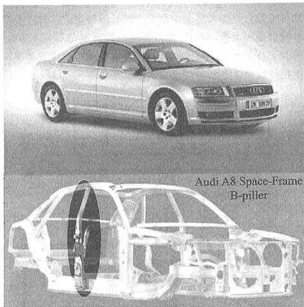
図1 レーザー・アークハイブリッド溶接を適用したアルミニウム合金製自動車の例
