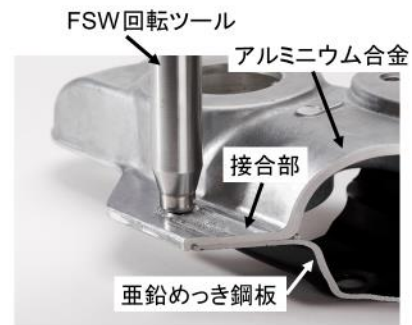
図4 鋼板とAl合金のFSWによる直接異種材料接合実用化例:サブフレーム重ね継手への展開 (ホンダ)
