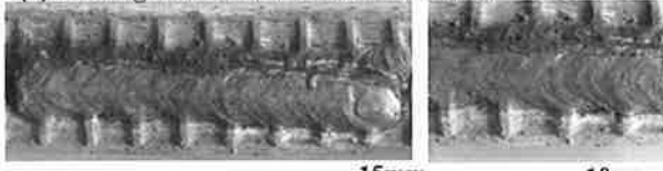
(d)Welding rod : D4340 Galvanized rebar size : D19
