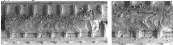
(d)Welding rod : D4340 Galvanized rebar size : D19
