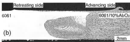
図13 FSWによる異材接合部断面組織: (a) ダイカスト材ADC12と展伸材A5052, (b) 10%Al 2 O 3 粒子分散6061基MMCと展伸材6061
