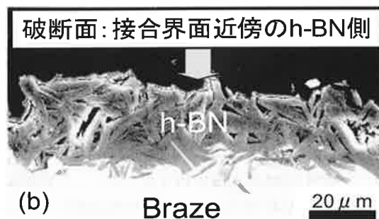
図14 (a)レーザーブレージング法の模式図と (b)セラミックスh-BNと超硬合金との接合部界面組織: Ag-Cu-Tiろう材使用
