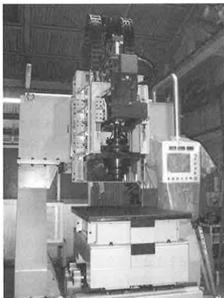
図4 阪大式複動型摩擦攪拌接合装置外観とツール先端部
