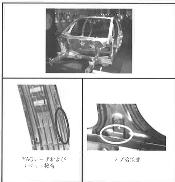
写真1 アウディA2 Bピラーの接合部 1)
