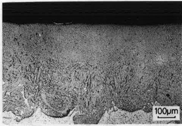
図12 レーザ合金化法(プリコート法)による鉄合金化層の断面形成組織(基材:A5052合金).
