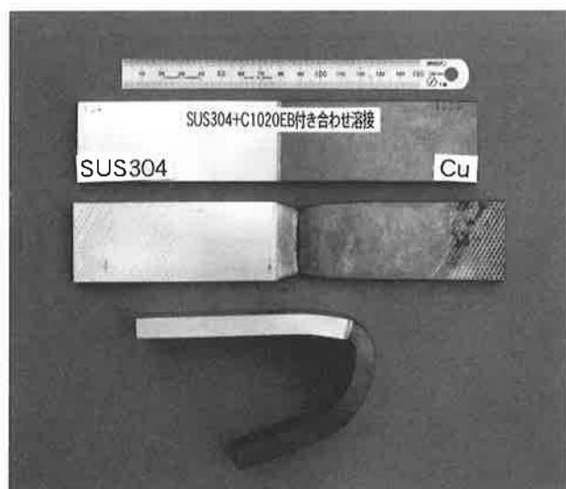
写真3 ステンレス鋼と銅の突合せ溶接継手の引張・曲げ試験片
