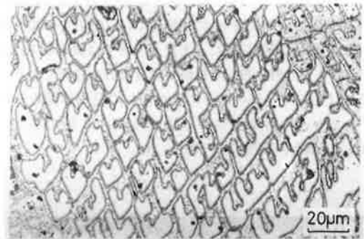
写真3 ティグ合金化層の組織：A1070 母材，Al-45% Cu 溶加棒 (富田ら)
